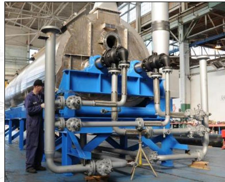
Шарнирные соединения подачи тепложидкости с гибкими трубными соединениями (компенсаторами).
